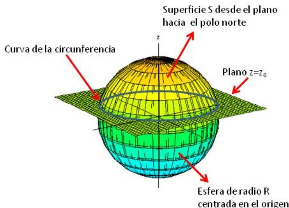
Figura 1: Esfera cortada por un plano paralelo al plano XY
