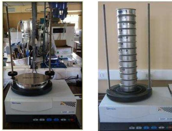
*Figura 3.14 Agitador de tamiz analítico.*
