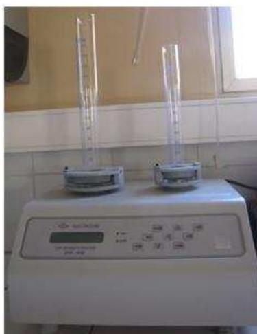
Figura 3.24 Equipo para medición densidad aparente.
