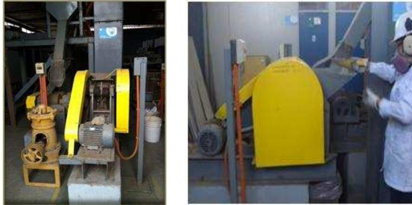
*Figura 3.9 Chancador de Mandíbula para disminución de tamaño del mineral.*
