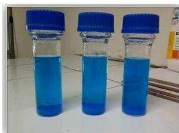
Figura 3.18 Soluciones sobresaturadas de  $\text{CuSO}_4$  + agua de Mar ácida a 25 °C.
