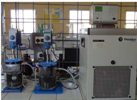
*Figura 3.15 Sistema de lixiviación por agitación.*
