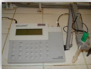
*Figura 3.7 Equipo para medición de pH y Eh.*
