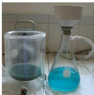
Figura 3.17 Sistema de filtración.
