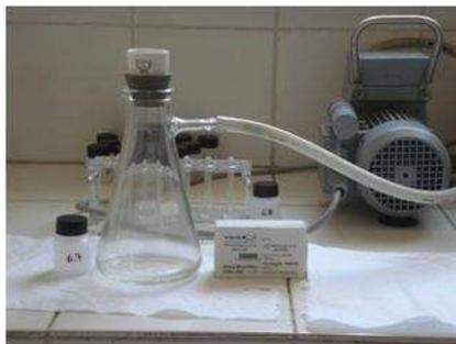
Figura 3.16 Sistema de filtración de muestras.
