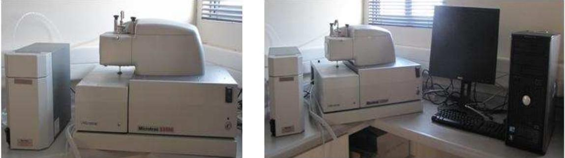
Figura 3.20 Analizador de tamaño de partícula automático Microtrac S3500.
