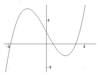
Se propone calcular la raíz que está cerca de 1.5 mediante el método de iteración del "punto fijo". Para esto se proponen dos descomposiciones de la ecuación f(x) = 0
