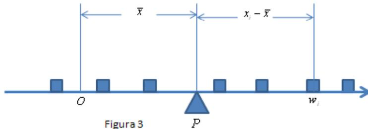
Con respecto al origen  $O$ , sea  $\bar{x}$  la distancia al punto de equilibrio  $P$ . (La barra debería permanecer horizontal si es suspendida por un cordel o soportada por un fulcro en esa posición). El equilibrio requiere que el torque total alrededor de  $P$  sea cero:
