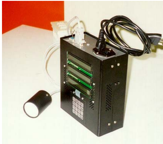
Figura 3: Equipo detector de radiación ultravioleta desarrollado en La Universidad de Santiago
